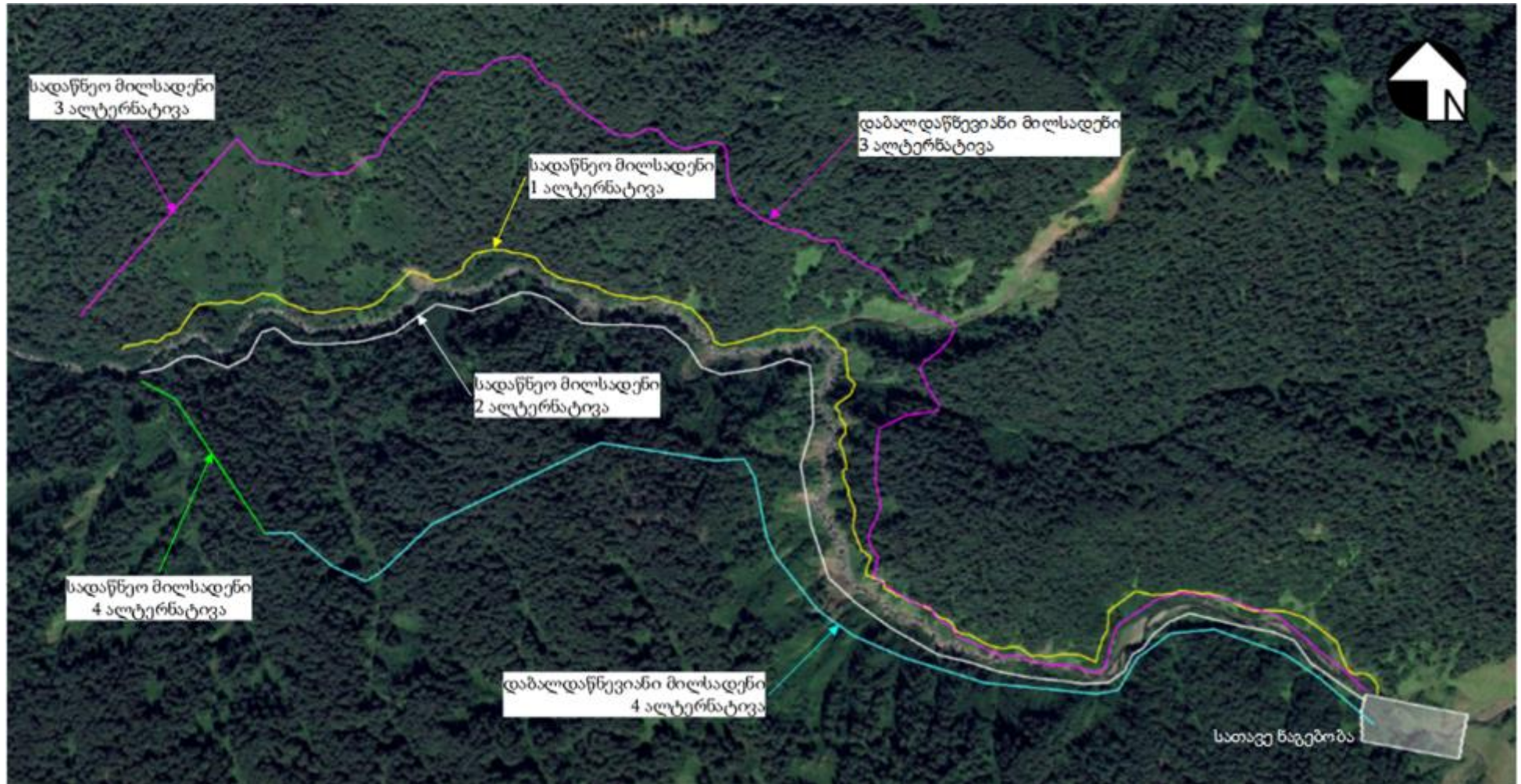
სურათი 3.2.1. სადანწეო სისტემის ალტერნატიული ვარიანტების სქემა
